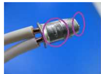
図 9 刻印間違いと芯線挿入不足
