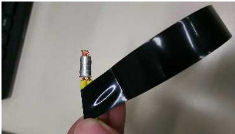
①余裕をもって 20mm 位下から反時計回りに巻き始める
