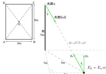
均等光源の光度 I を求めた後, 1 灯分の水平面照度  $E_h$  を求め, B,C,D からの光源分があるので 4 倍する。
