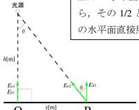
点 O の水平面照度を求め、点 P における水平面直接照度は題意から、その 1/2 とする。次に x[m] の値を求める際には、点 O と点 P の水平面直接照度との比から x の値を求める。
